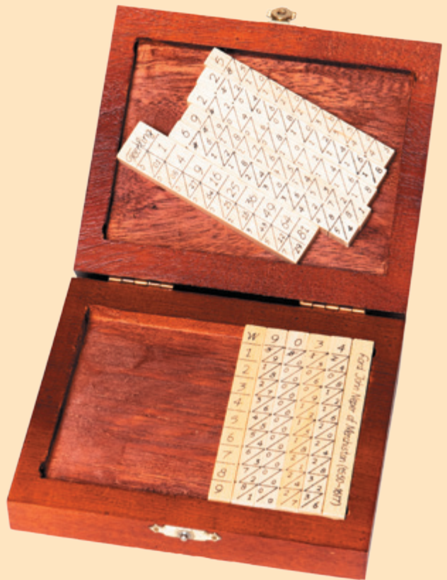
Палочки шотландского математика Джона Непера, изобретённые им в 1614 году, позволяя быстро совершать все четыре арифметических действия
